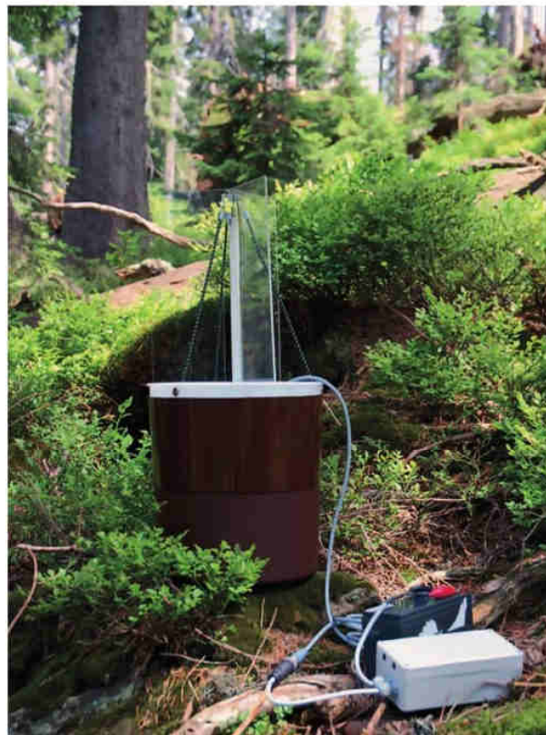
Obr. 3 – Přenosný světelný lapač na lokalitě Trojmezdná (foto R. Modlinger 2006). Fig. 3 – Portable light trap on the locality Trojmezdná (photo by R. Modlinger 2006).
