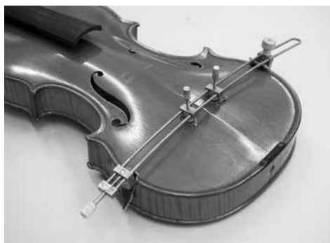
Housle v průběhu lepení desky.
